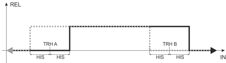
Rysunek 3. Charakterystyka działania wyjść przekaźnikowych przetwornika w przypadku dwóch progów (opcja 5-var2)
